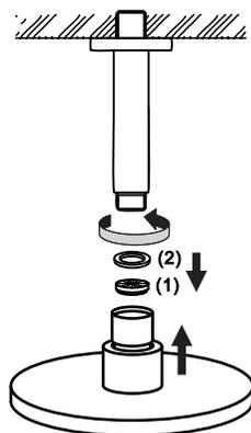
O regulador de vazão pode já vir montado de fábrica na ducha. Recomenda-se a remoção do regulador para instalações onde a pressão seja inferior a 10 m.c.a. Não instale a ducha sem o regulador caso a pressão seja superior a 15 m.c.a.
