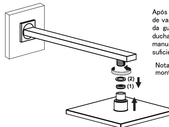
Após o tubo instalado, insira o regulador de vazão (1) na rótula da ducha, seguido da guarnição (2), finalize rosqueando a ducha no tubo. Promova um aperto manual do chuveiro contra o tubo, suficiente para comprimir a guarnição.
