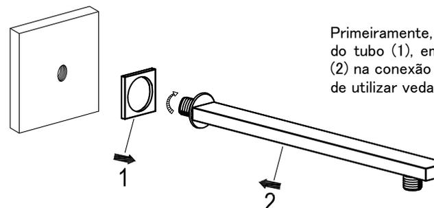
Primeiramente, insira a canopla na rabetada do tubo (1), em seguida, rosqueie o tubo (2) na conexão na parede. Não se esqueça de utilizar veda rosca na conexão.
