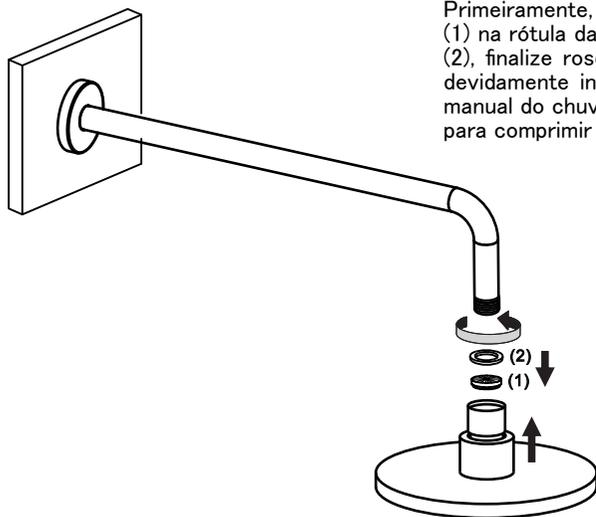
Primeiramente, insira o regulador de vazão (1) na rótula da ducha, seguido da guarnição (2), finalize rosqueando a ducha no tubo já devidamente instalado. Promova um aperto manual do chuveiro contra o tubo, suficiente para comprimir a guarnição.
